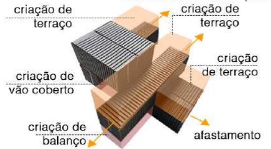
Figura 4.9 - Estratégias para a construção arquitetônica com containers convencionais de 20 pés e 40 pés.
