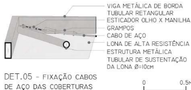
Figura 7.64 - Detalhe 05 fixação dos cabos de aço das coberturas.
