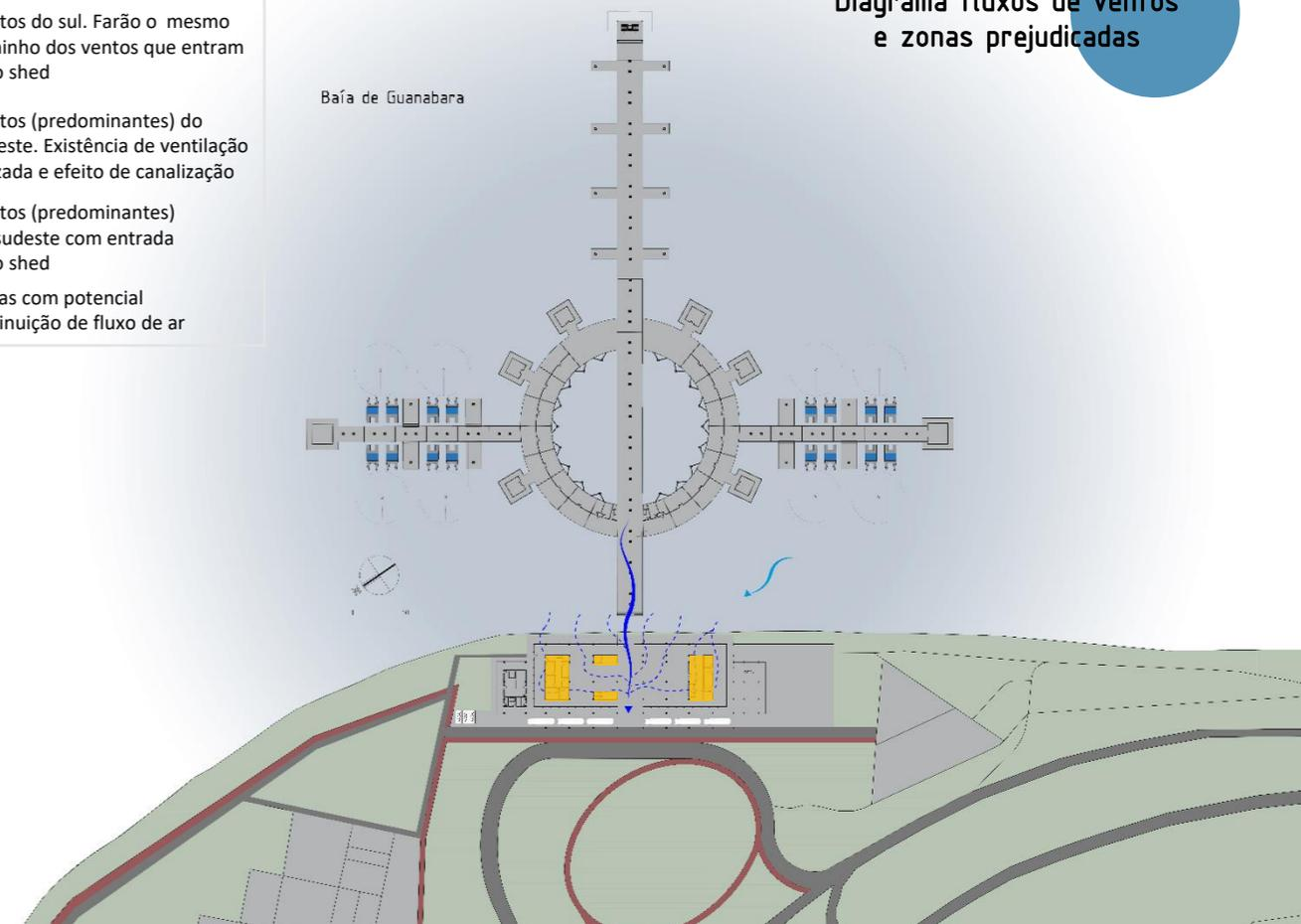
Figura 7.74: Diagrama de análise de fluxos de ventilação e de zonas com potencial diminuição de fluxo de ar.
